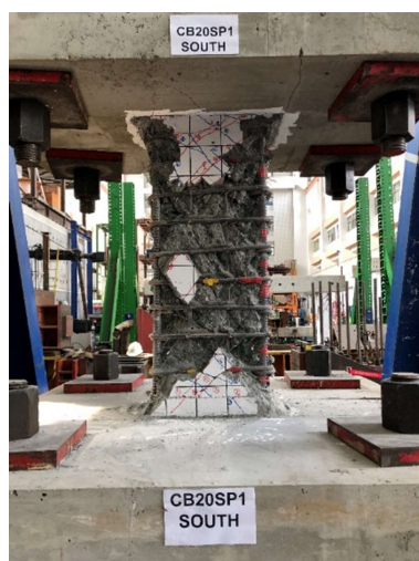
圖 9 試體 CB20SP1 最終破壞情形
