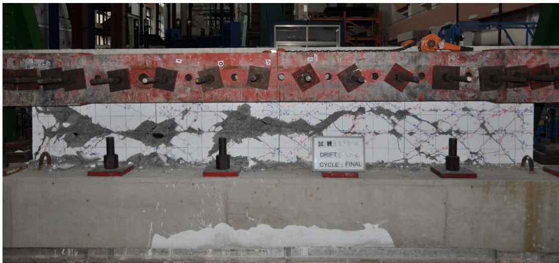
圖 16 試體 EFB-16 最終破壞照(Drift Ratio = 3%)[左側為西]
