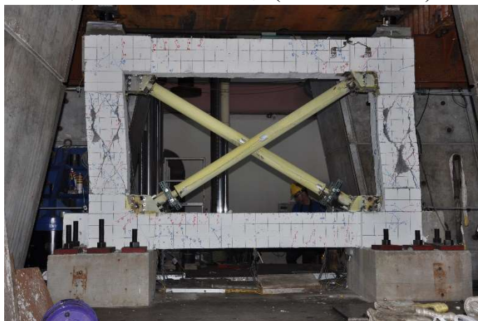
圖 8 實驗最終破壞照片 (Drift Ratio : 2.5%)
