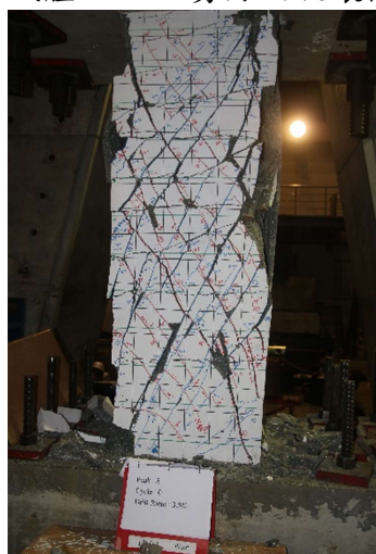
(i) 試體 15S0.3 剪力面破壞情形
