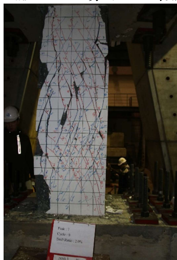
(k) 試體 20S0.3 剪力面破壞情形
