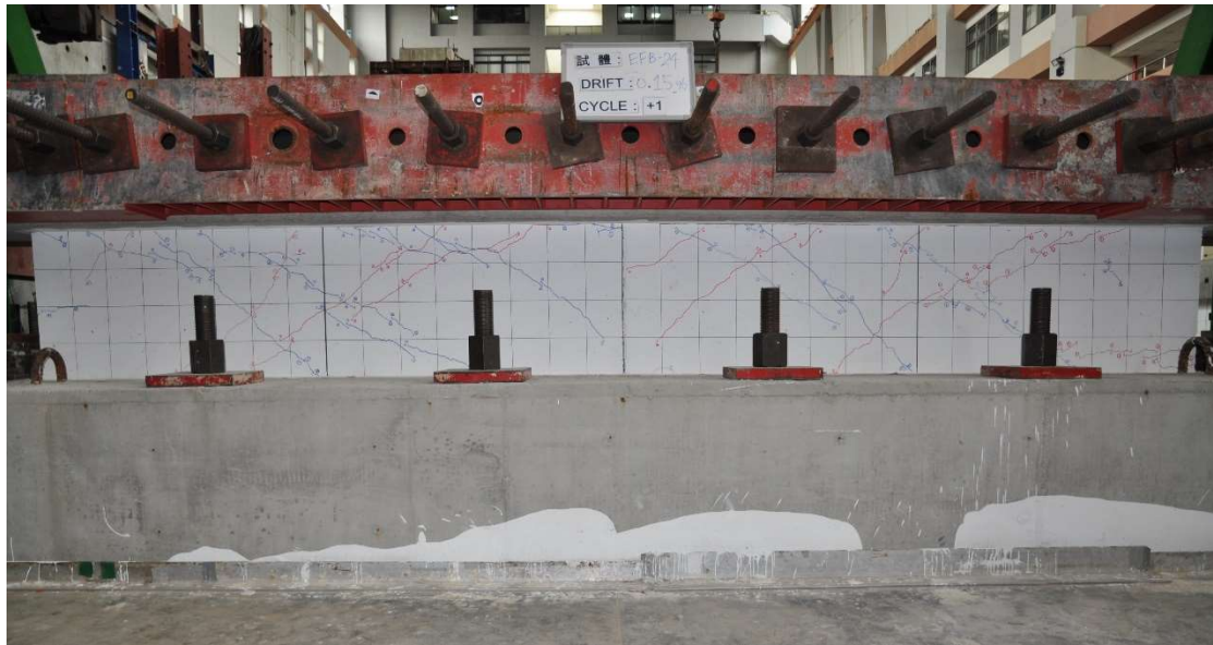
圖 19 試體 EFB-24 強度點正面照(Drift Ratio = 0.15%)[左側為西]
