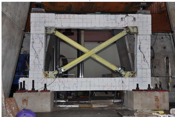
圖 7 強度點試體照片 (Drift Ratio : 2%)
