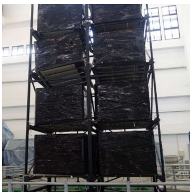
圖 35 四層兩跨破壞(尼龍擋塊+隔震墊)
