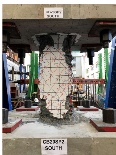
圖 11 試體 CB20SP2 最終破壞情形
