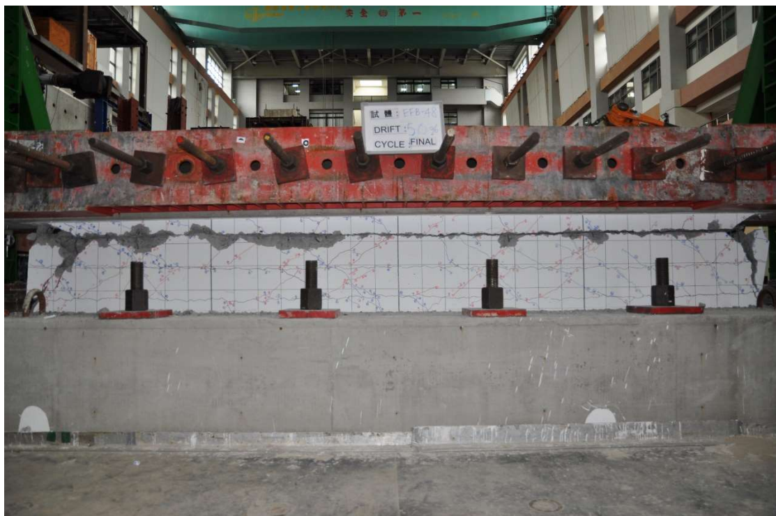
圖 24 試體 EFB-48 最終破壞照(Drift Ratio = 5%)[左側為西]
