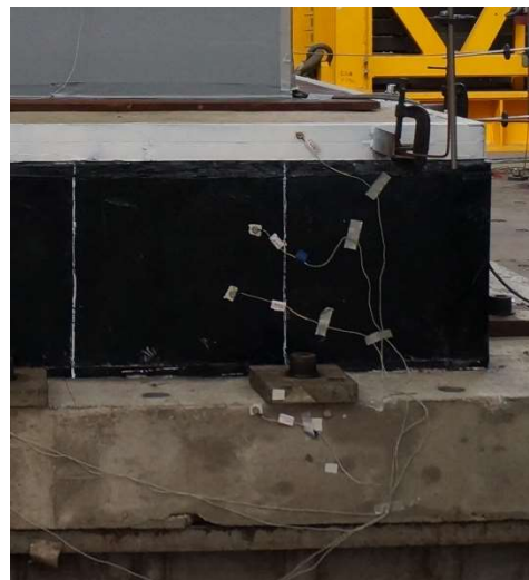
圖 11 光學量測系統(NDI)安裝示意
