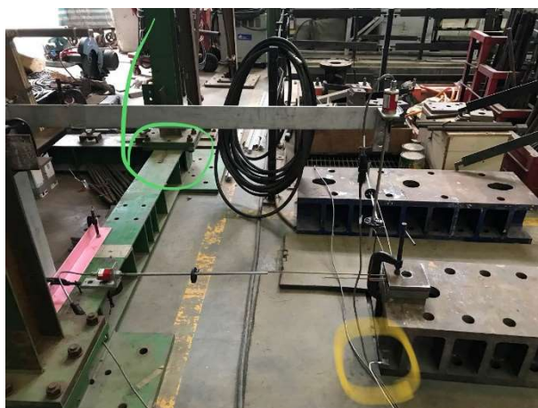
圖 6、振動台浮動反力質塊的加速規以及位移計架設示意圖(左上)
