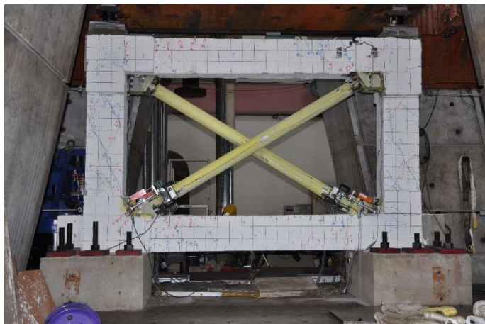
圖 6 裂縫發展 (Drift Ratio : 1%)
