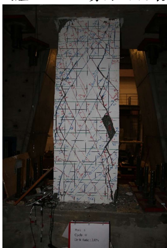
(c) 試體 15S0.15 剪力面破壞情形
