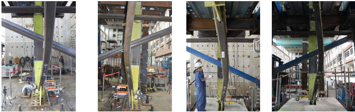
(a) 1SBr at -0.45%(1) (b) 1NBr at +0.45%(2) (c) 2SBr at -0.6%(1) (d) 2NBr at +0.6%(2) 圖 6 試體各斜撐初始挫屈之照片
