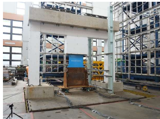
圖 6 試體二安裝完成圖
