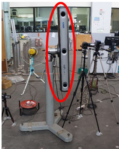
圖 11 光學量測系統(NDI)安裝示意
