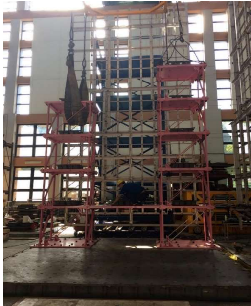
圖 1 雙塔鋼構構架
