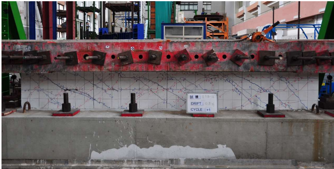
圖 15 試體 EFB-16 強度點正面照(Drift Ratio = 0.8%)[左側為西]
