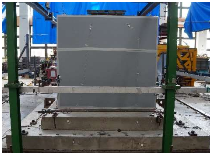
a. 上部結構基礎採固接
