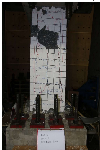
(l) 試體 20S0.3 撓曲面破壞情形
