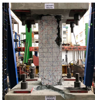
圖 15 試體 CB30SP1 最終破壞情形
