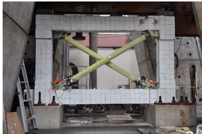
圖 5 裂縫發展 (Drift Ratio : 0.5%)
