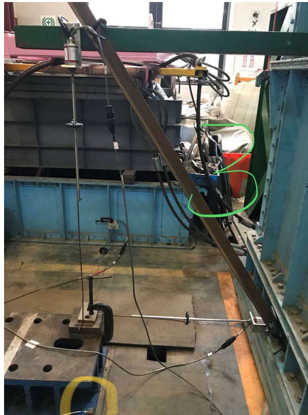
圖 3、振動台浮動反力質塊的加速規以及位移計架設示意圖(右上)
