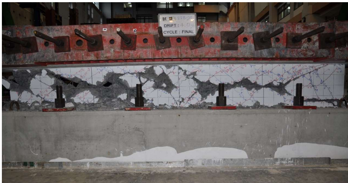
圖 20 試體 EFB-24 最終破壞照(Drift Ratio = 4%)[左側為西]
